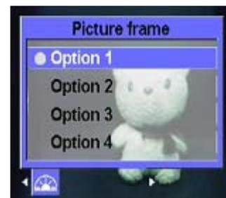
Par exemple : si vous sélectionnez l'option—configuration, appuyez sur OK pour confirmer, et appuyez sur MENU pour rentrer à la prise de vue. Sur le LCD, un cadre sera affiché, alors vous pouvez photographier en cadrant le viseur sur 'objet.
