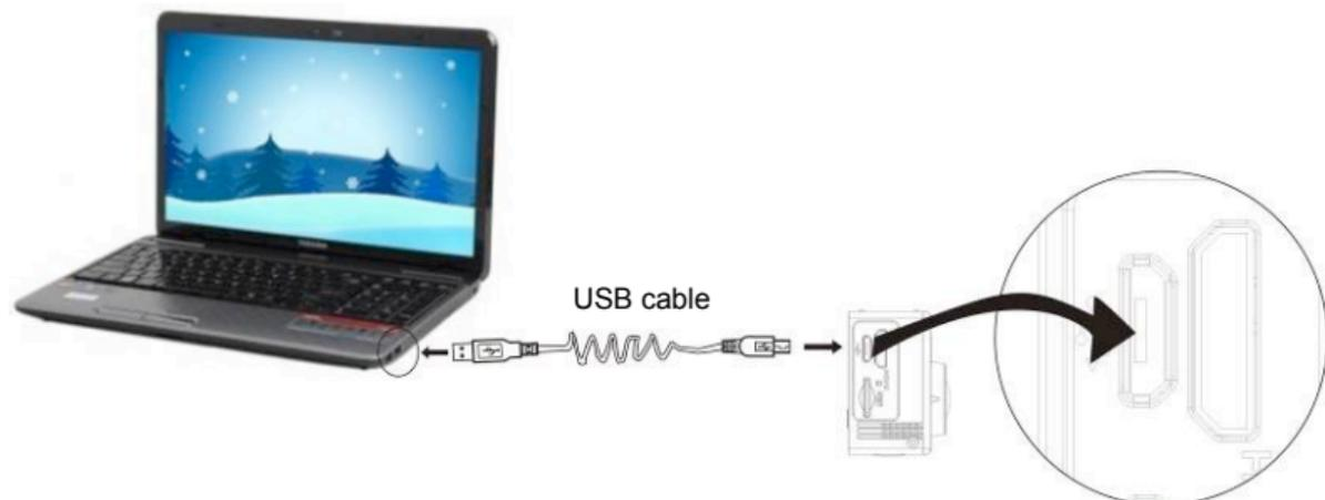
Conecte la cámara al ordenador para cargarla, en ese momento, el indicador de carga se volverá azul y se apagará cuando este cargada. Normalmente, la batería tardará 2-4 horas en cargarse.
