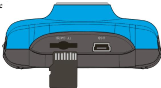
**Nota:** Esta videocámara no dispone de memoria integrada. Asegúrese de insertar una tarjeta de memoria antes de utilizar la cámara.
