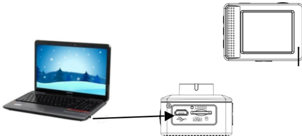
Schließen Sie die Kamera im ausgeschalteten Zustand zum Laden an den Computer an. Die Ladeanzeige leuchtet während der Ladung und erlischt, wenn die Batterie vollständig geladen ist. Im Allgemeinen ist die
