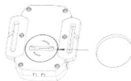
(Abbildung 4, Batteriefachabdeckung schließen)
