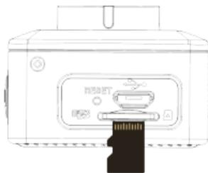
**Hinweis: Die Kamera verfügt nicht über einen eingebauten Speicher. Bitte führen Sie die Speicherkarte vor der Verwendung der Kamera ein. Die Speicherkarte muss vor der Benutzung der Kamera in der Kamera formatiert werden.**
