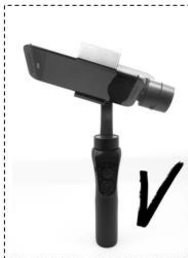
Etapa 3: Ligue o gimbal/estabilizador pressionando o botão de ligar/desligar por 3 segundos. Quando o gimbal/estabilizador ligar, este alinha-se automaticamente.
