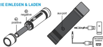
Verwenden Sie das beiliegende USB-Kabel, um das Gerät mit einem PC, einem externen Akku oder mit einem USB-Netzteil zu verbinden um es aufzuladen.
