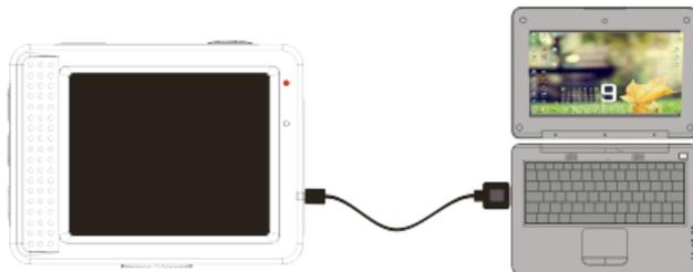
Schließen Sie die Kamera im ausgeschalteten Zustand zum Laden an den Computer an. Die Ladeanzeige leuchtet während der Ladung und erlischt, wenn die Batterie vollständig geladen ist. Im Allgemeinen ist die Batterie nach 2-4 Stunden vollständig geladen.
