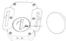
(Abbildung 1, Batteriefachabdeckung öffnen)
